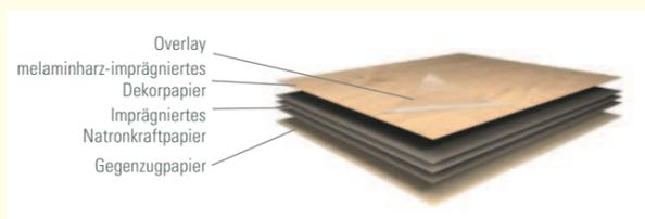
Dekorschichtstoffe auf Basis härterer Harze gefertigt aus mehreren gepressten Papierschichten: melaminharz-imprägniertes Dekorpapier als Oberfläche und eine oder mehrere, mit Phenolharz imprägnierte Kernlagen (EN438-3).
