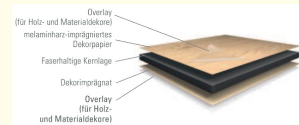
EGGER Kompaktplatten sind Kompakt-Schichtpressstoffe gemäß EN 438-4 und EN 438-8. Eine faserhaltige Kernlage und mit Melaminharzen imprägnierte Dekorpapiere werden unter hohem Druck und hoher Temperatur miteinander verpresst. Kompaktplatten mit Dekordruck (Holz- und Materialreproduktionen) werden mit Overlay produziert.
