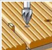
Die Position der Schrauben mit einem Bleistift anzeichnen. Löcher vor dem Verschrauben vorbohren. Bohrlöcher mit einem Senker ausreiben.
