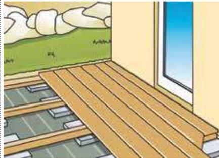
Beginnen Sie bei parallel zur Hauswand verlegten Dielen an der Hauswand. Beachten Sie einen Dehnungsabstand zur Hauswand von mind. 10–15 mm und einen Fugenabstand von 3–8 mm je nach Holzart, Produkttyp und Herstellerempfehlungen.
