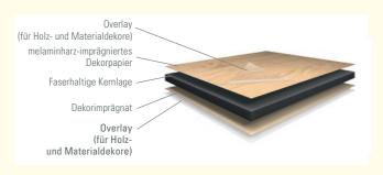
EGGER Kompaktplatten sind Kompakt-Schichtpressstoffe gemäß EN 438-4 und EN 438-8. Eine faserhaltige Kernlage und mit Melaminharzen imprägnierte Dekorpapiere werden unter hohem Druck und hoher Temperatur miteinander verpresst. Kompaktplatten mit Dekordruck (Holz- und Materialreproduktionen) werden mit Overlay produziert.
