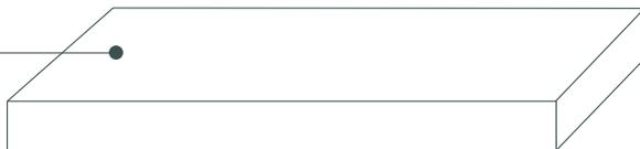
Acrylharzgebundener Mineralwerkstoff nach DIN EN ISO 19712, 12 mm. Oberseite nass geschliffen (P 600), Rückseite Trockenschliff (P 80). Oberfläche mit Folie geschützt.
