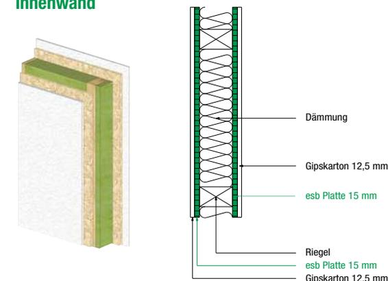
Die aufgezeigten beispielhaften Aufbauten in Wand, Decke und Dach sind exemplarische Darstellung. Sie ersetzen nicht die bauphysikalische Berechnung im Einzelfall unter Berücksichtigung aller örtlichen Gegebenheiten. Die aufgeführten Beispiele stellen Informationen dar ohne Zusicherung von Eigenschaften.
